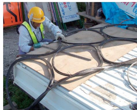
発想の原点となったエンジンベルトをつないで『ピタリング』の試作品をつくる作業員
