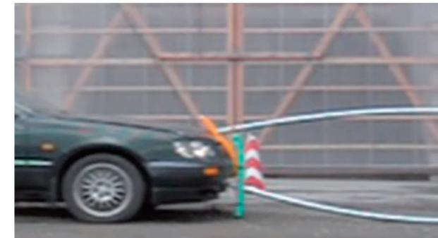
時速 55km で『バリバン』に車を衝突させ、単管パイプの突き抜け抑制効果を検証する実験のようす。下川原さんがハンドルを握った
